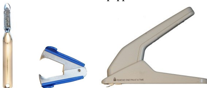
Bild 3. Exempel på verktyg som kan användas vid borttagning av nitar/häftklamrar
